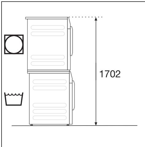
Die Waschmaschine kann mit einem Miele Trockner als Wasch-Trocken-Säule aufgestellt werden. Dazu ist ein Verbindungssatz (nachkaufbares Zubehör) erforderlich.
