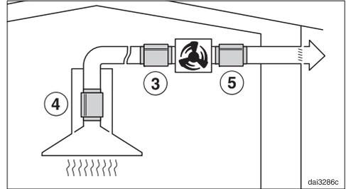
En caso de funcionamiento con un motor externo es posible minimizar los ruidos del motor hacia fuera y en la cocina. Al colocar un silenciador antes del motor externo ③, se evitan los ruidos en la cocina. En caso de una conducción de salida de aire larga el silenciador deberá colocarse en la boca de salida de aire de la campana extractora ④.
