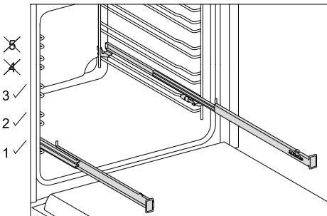
FlexiClip teleskopske vodilice mogu se ugraditi samo u razine 1, 2 i 3
