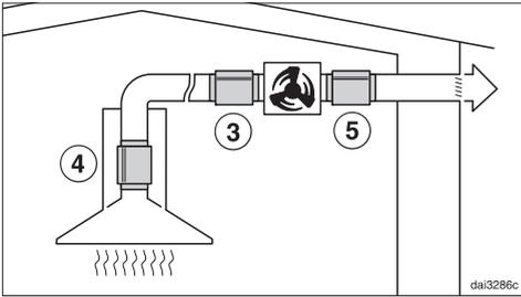
Um Gebläsegeräusche in der Küche zu minimieren, ist der Schalldämpfer möglichst vor dem externen Gebläse zu positionieren ③, bei einer langen Abluftleitung am Abluftstutzen der Dunstabzugshaube ④. Bei einem externen Gebläse, das im Haus montiert ist, ist durch Einsatz eines Schalldämpfers hinter dem externen Gebläse ⑤ eine Verringerung der Gebläsegeräusche nach aussen möglich.
