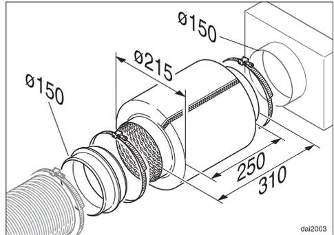
In die Abluftleitung kann ein Schalldämpfer eingesetzt werden (nachkaufbares Zubehör). Er dient zur zusätzlichen Geräuschkämpfung.
