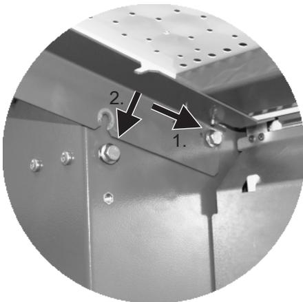
Einsetzen des Wäscheabnahmetisches am linken Seitenständer.
