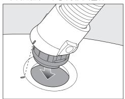
■ 將吸喉接頭插入吸塵機的吸氣口,直 至其卡入就位。首先將兩個部分的指 示線對齊。
