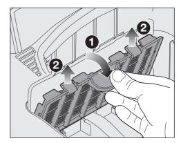
■ 向前鬆開摩打保護濾網並從塵格中向 上取出濾網。
