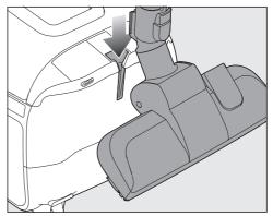
■將吸頭插入吸塵機上的停放系統。
