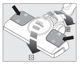
伸出除塵刷清潔平滑而不易刮花的堅硬 地板,以及有罅隙或深縫的地板:
