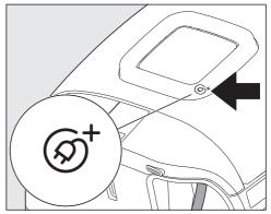
■ 踏一下電線回捲腳踏。然後電線將自動收回至吸塵機中。您可以隨時中斷電線回捲。
