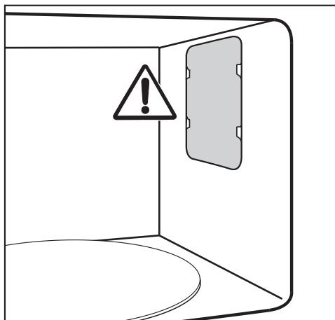
Não retire a cobertura situada no interior do forno, na zona de saída de micro-ondas, assim como a folha no interior da porta.
