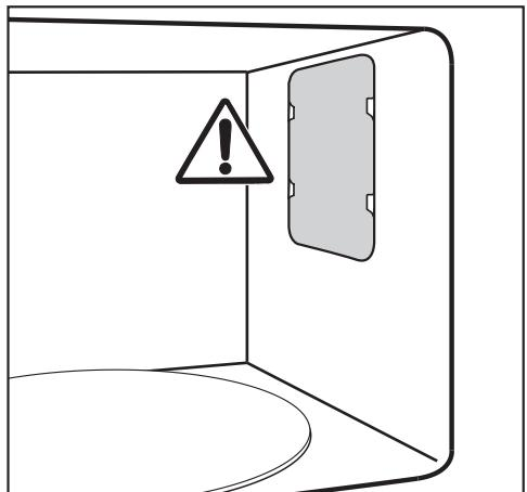
Não retire a cobertura diante da abertura de saída de micro-ondas no interior do forno, assim como a película no interior da porta.
