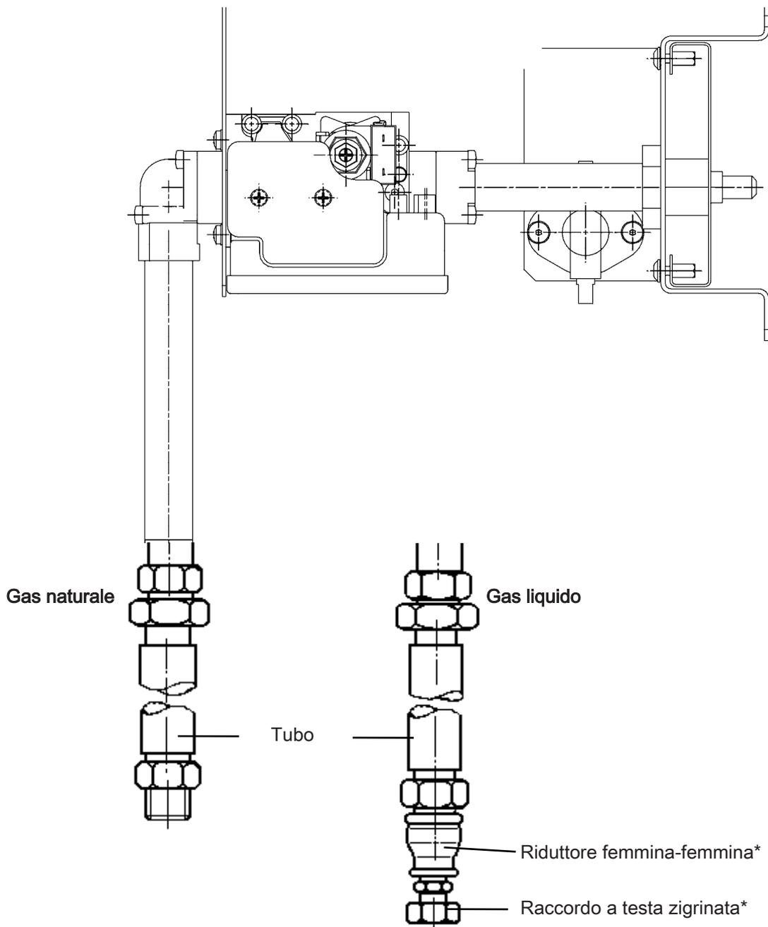
\* Allegato al "Kit di modifica per il passaggio da gas naturale a gas liquido".
