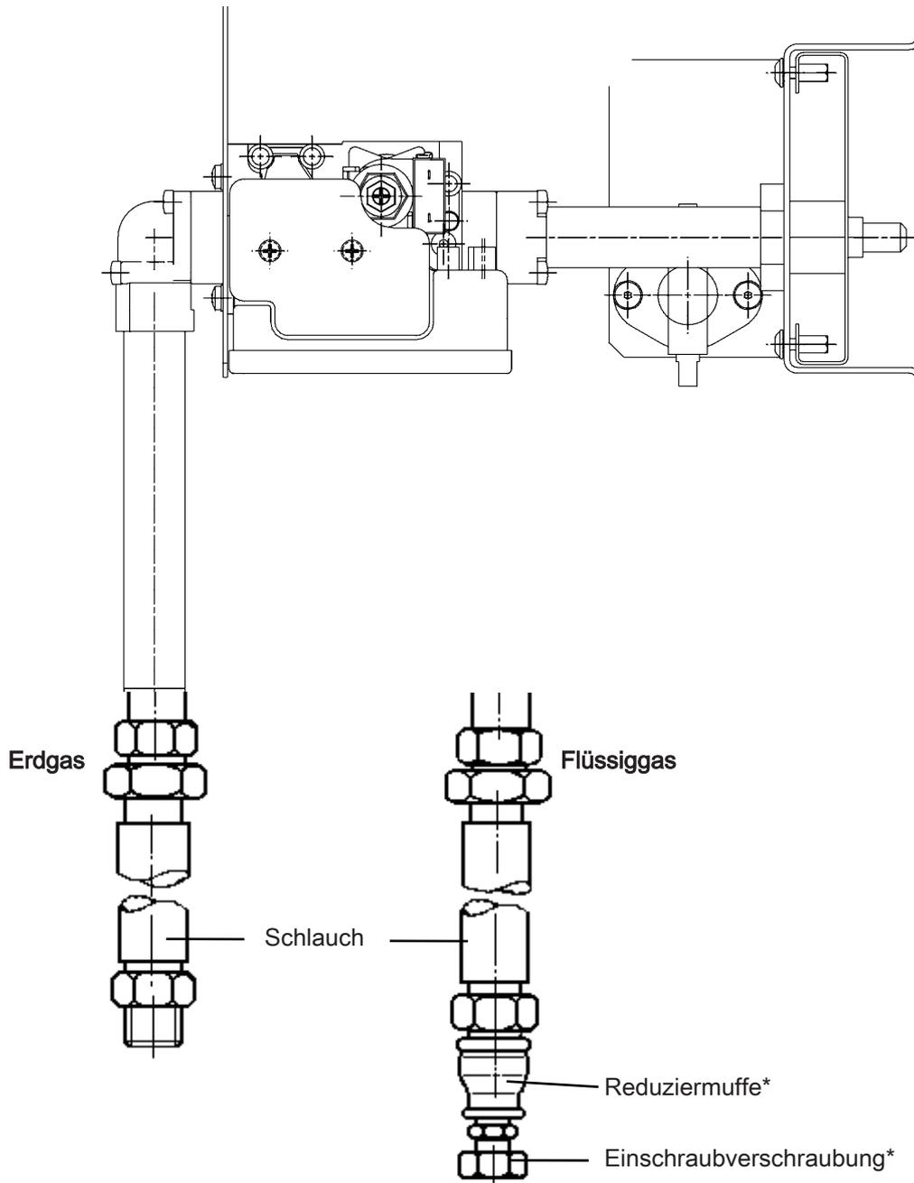
\* Liegt dem Umbausatz von Erdgas in Flüssiggas bei.
