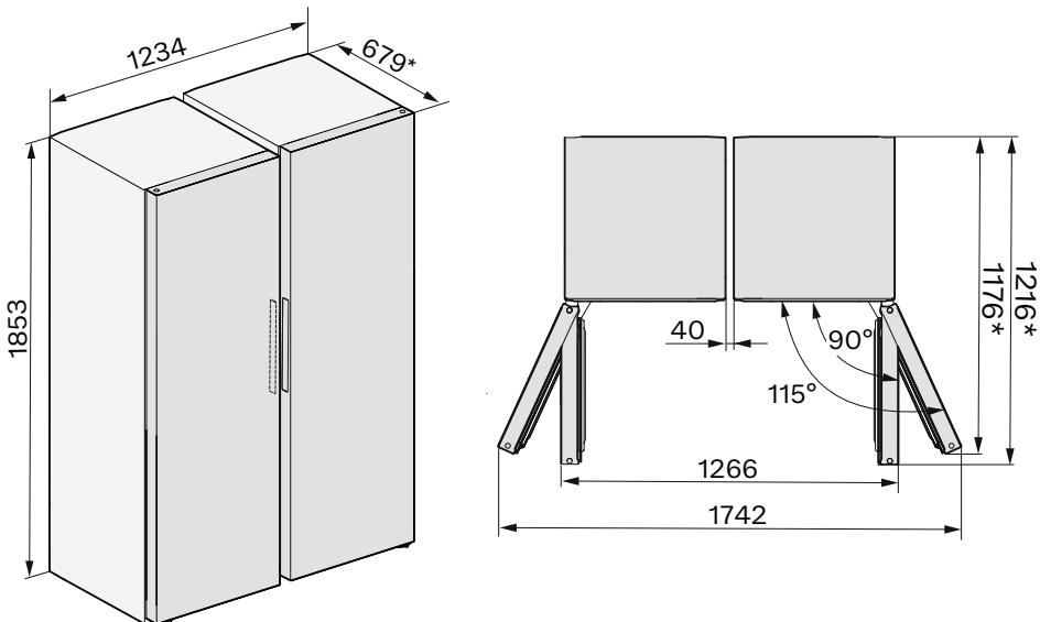
\* Διαστάσεις χωρίς τοποθετημένους αποστάτες τοίχου. Αν χρησιμοποιηθούν οι παρεχόμενοι αποστάτες τοίχου, το βάθος της συσκευής αυξάνεται κατά 15 mm.
