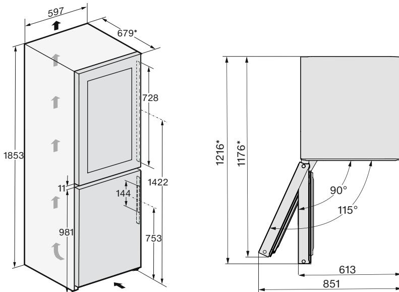
\* Διαστάσεις χωρίς τοποθετημένους αποστάτες τοίχου. Αν χρησιμοποιηθούν οι παρεχόμενοι αποστάτες τοίχου, το βάθος της συσκευής αυξάνεται κατά 15 mm.
