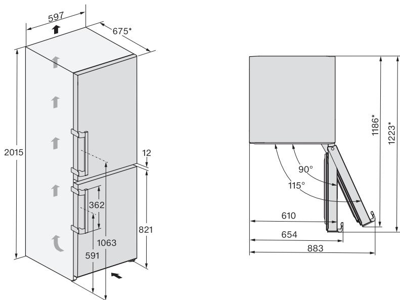
\* Dimenzije bez montiranih zidnih odstojnika. Ukoliko se koriste zidni odstojnici, povećava se dubina uređaja za 15 mm.
