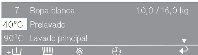
Indicación del display con el campo de entrada «Temperatura» marcado
