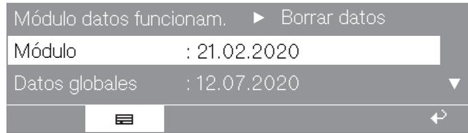
Con el punto de menú **Módulo** se borran los Total de datos y los Datos del programa de los Datos de funcionamiento.
