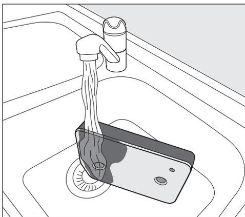
**Remarque :** Pour que les résidus présents sur la surface se détachent plus rapidement, faites passer un jet d'eau à la verticale sur la face avant du filtre de socle.
