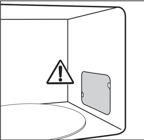
No retire la tapa de la apertura para la salida de las microondas situada en el interior y tampoco la lámina que protege la parte interior de la puerta.
