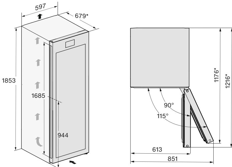
\* Διαστάσεις χωρίς τοποθετημένους αποστάτες τοίχου. Αν χρησιμοποιηθούν οι παρεχόμενοι αποστάτες τοίχου, το βάθος της συσκευής αυξάνεται κατά 15 mm.
