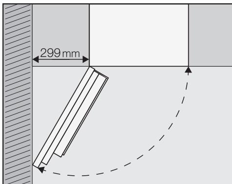
**提示:** 如果墙壁和咖啡机之间保持至少 299 毫米的间隙，则您可以将电器机门打开得更大，使咖啡机更易于使用。例如，会更容易拆下左侧咖啡豆容器。
