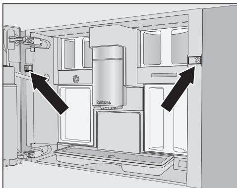
电器配有 2 个 TX 20 (25 毫米) 螺丝。
