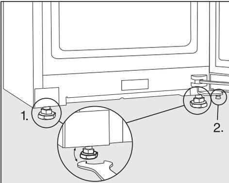
■ Alinhe o aparelho de frio com recurso a um nível de bolha de ar e a chave de bocas fornecida e apoie a porta do aparelho.
