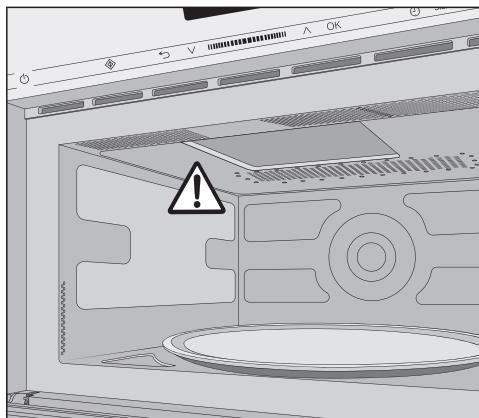
N'enlevez pas le cache de protection de l'orifice de sortie des micro-ondes.
