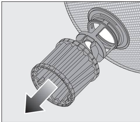
■ Для очистки внутренней стороны фильтра снимите с комбинированного фильтра микрофильтр, потянув его за пластиковое кольцо вниз.
