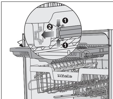
■ Сожмите предохранительные скобы направляющих по обеим сторонам выдвижного поддона для столовых приборов **1** и одновременно снимите предохранительные скобы **2**.
