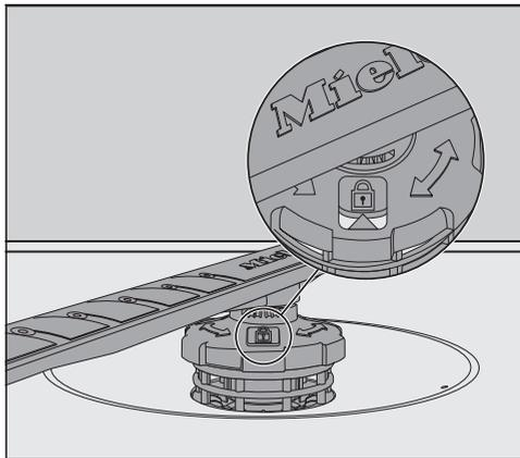
■ Поверните резьбовое соединение по часовой стрелке так, чтобы стрелка в смотровом окошке указывала на символ замка
