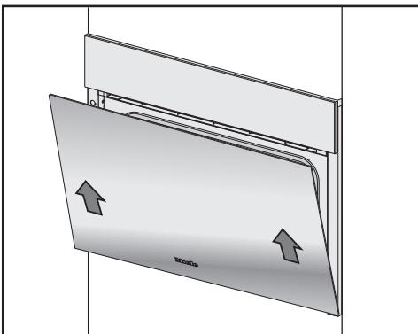
Wenn die Sperrbügel nicht verriegelt sind, kann sich die Tür von den Halterungen lösen und beschädigt werden. Verriegeln Sie die Sperrbügel unbedingt wieder.
