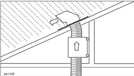
Bei senkrechter Montage des Abluftgebläses und direkter Abluftführung über Dachflächen muss durch Verwendung der Dachdurchführung DDF 125/150 oder anderer entsprechender Maßnahmen sichergestellt sein, dass kein Niederschlag wie Regen oder Schnee in den Abluftaustritt eindringen kann.
