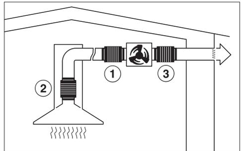
Um Gebläsegeräusche in der Küche zu minimieren, ist der Schalldämpfer möglichst vor dem externen Gebläse zu positionieren ①, bei einer langen Abluftleitung am Abluftstutzen der Dunstabzugshaube ②. Bei einem externen Gebläse, das im Haus montiert ist (ABLG 202), ist durch Einsatz eines Schalldämpfers hinter dem externen Gebläse ③ eine Verringerung der Gebläsegeräusche nach außen möglich.
