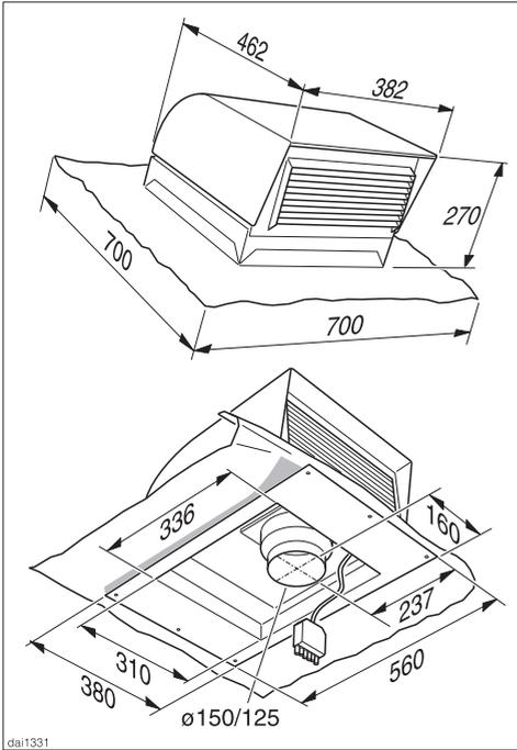
Das Dachgebläse DDG 102 ist für die Montage auf schrägen Ziegel-, Dachstein-, Schiefer- oder Schindeldächern vorgesehen. Die Dachneigung muss mindestens 22° betragen, damit keine Niederschläge wie Regen oder Schnee eindringen können.
