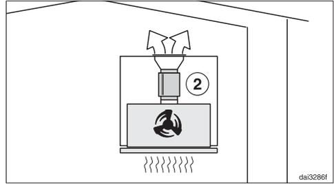
Bei Umluftbetrieb wird der Schalldämpfer zwischen Ausblasstutzen und Ausblaskitter positioniert ②. Prüfen Sie den Einbauraum.
