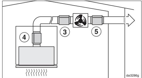
Bei Betrieb mit einem externen Gebläse können die Gebläsegeräusche nach außen und in der Küche minimiert werden. Wenn der Schalldämpfer vor dem externen Gebläse ③ positioniert wird, verringern sich die Geräusche in der Küche. Bei einer langen Abluftleitung muss der Schalldämpfer am Abluftstutzen der Dunstabzugshaube ④ positioniert werden.
