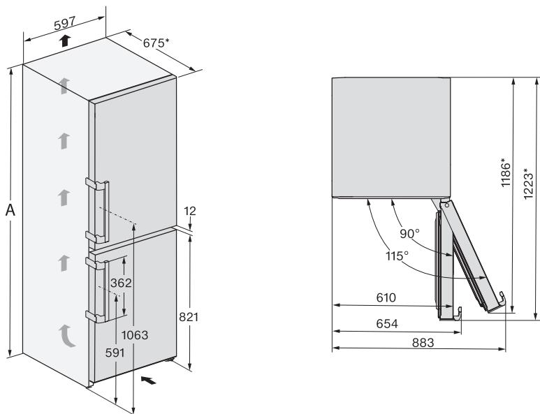
\* Dimenzija bez postavljenog dodatka za odmak od zida. Ako se koriste priloženi dodaci za odmak od zida, dubina za ugradnju uređaja povećava se za 15 mm.
