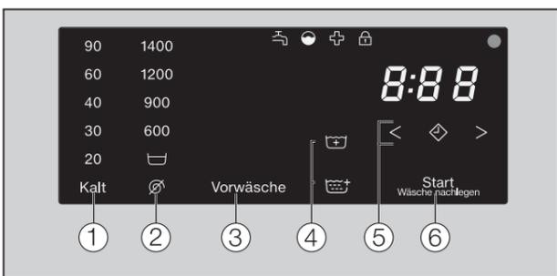
Die Sensortasten 1-6 reagieren auf Berührung mit den Fingerspitzen. Die Auswahl ist möglich, solange die jeweilige Sensortaste beleuchtet ist.
