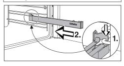
Insérez le rail coulissant FlexiClip par l'avant, sur la barre inférieure d'un niveau de cuisson (1.) et faites-le glisser le long de la barre dans l'enceinte de cuisson (2.).
