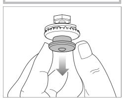
Tirez le bouchon de pression avec précaution vers le bas. La résistance de voûte/ gril s'abaisse automatiquement. Nettoyez la voûte exclusivement avec une lavette éponge ou une éponge à vaisselle propre (voir chapitre « Nettoyage et entretien », section « Enceinte »).
