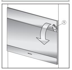
Insérez le déverrouilleur fourni ① sur le côté droit à env. 3 cm dans la fente entre la porte et le bandeau de commande et ouvrez la porte en tirant vers l'avant. Risque de blessure en raison des surfaces brûlantes.
