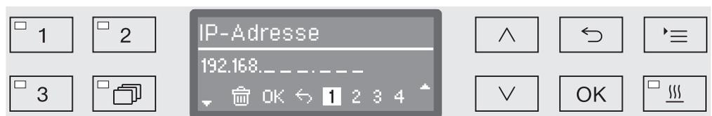
In der mittleren Zeile wird die aktuelle Einstellung ausgegeben. Diese kann mit den Optionen aus der unteren Zeile bearbeitet werden. Die oberste Zeile nennt die jeweils ausgewählte Option aus der unteren Zeile. Nachfolgende Eingabemöglichkeiten stehen zur Verfügung:
