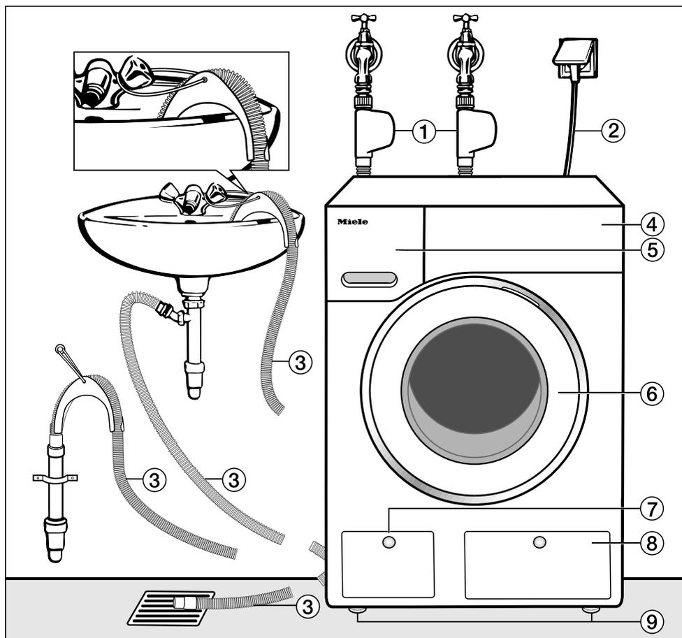
① Système Aquasécurité sur les tuyaux d'arrivée d'eau, pour eau froide (eau potable) et autres types d'eau
